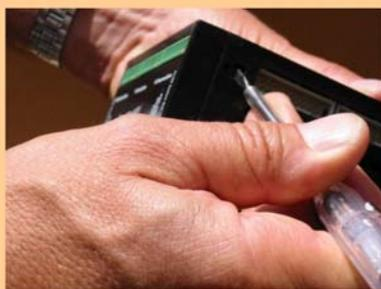
Entfernen Sie die Schrauben an der Ober- und Unterseite des Moduls. Öffnen Sie mit einem Schraubendreher oder ähnlichem Werkzeug die Halterungslaschen neben den Verschraubungen.
