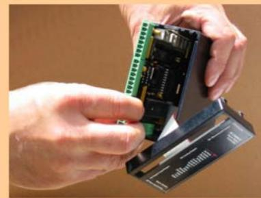
Entfernen Sie vorsichtig die Modulabdeckung. Achtung! Die LED-Anzeigen sind fest mit dem Deckel verbunden. Ziehen Sie dann langsam die Hauptplatine heraus.
